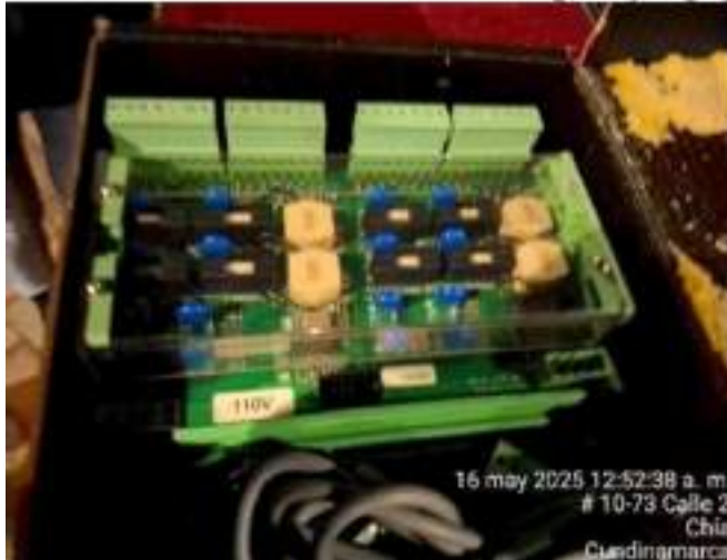
Ilustración 4. Registro fotográfico cambio tarjeta CPU principal.
